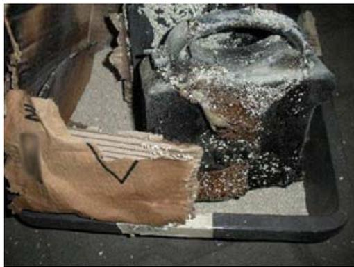
图1c 与损毁锂电池相同的货物的内包装、外包装及标签
