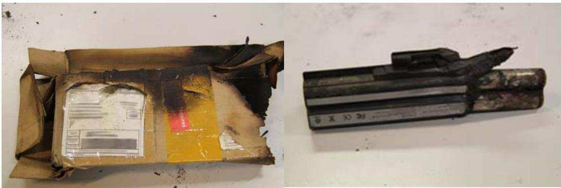
图4 两枚以信封包装，「未经申报」的锂离子电池发生火警
