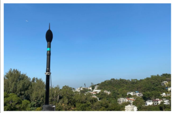
圖 2-4：戶外噪音監察站
