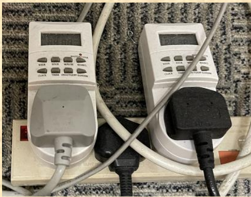
圖 5-3 連接影印機的節能計時器
