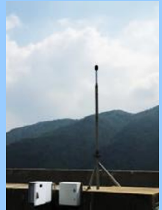
圖 2-4：戶外噪音 監察站
