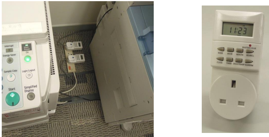
圖 5-1：連接至影印機的節能計時器(左)和節能計時器裝置(右)
