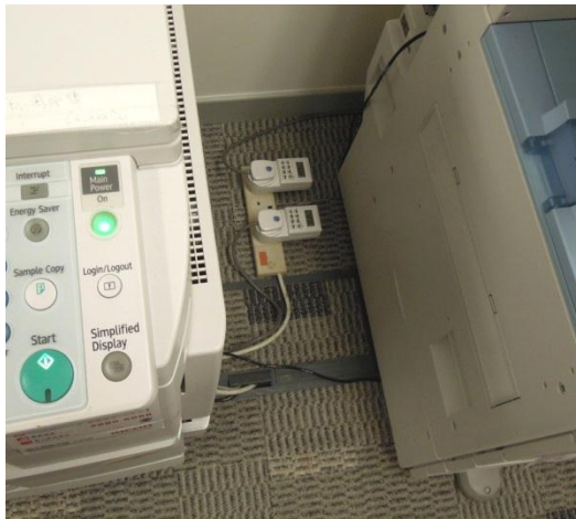
圖 5-10：連接至影印機的節能計時器(左)和節能計時器裝置(右)
