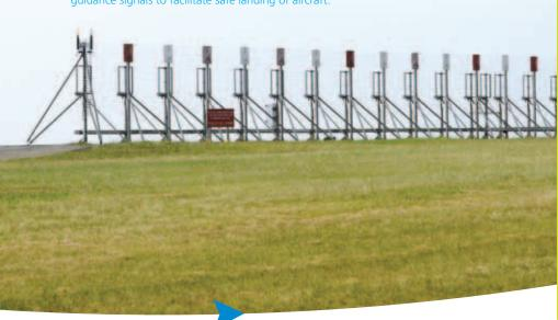
下滑道天線提供準確的下降指引訊號, 引導航機降落。
