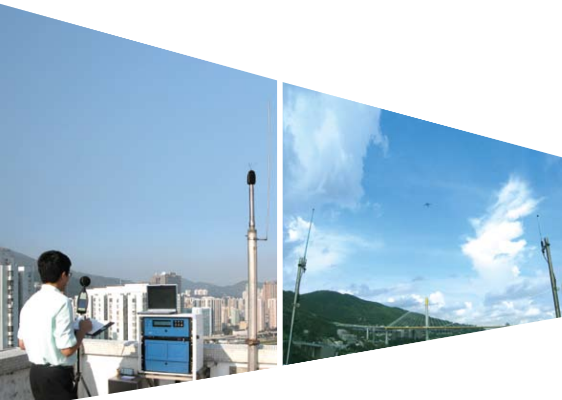
左圖：本處人員正收集飛機噪音數據。
