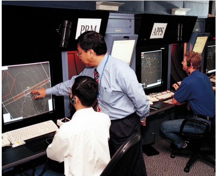
精密跑道監察系統監察飛機進場着陸機場兩條跑道的情况。
