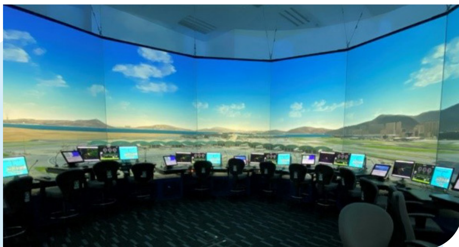
New 360° projection system of the new CTS at CAD HQs. 位於民航處總部的新指揮塔模擬器360°全景影像投影系統。
