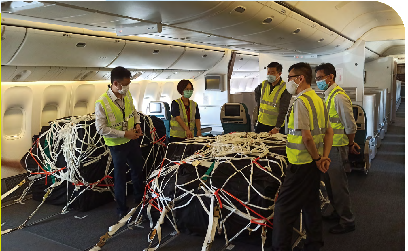
The CAD colleagues inspect cargo carriage in passenger cabin of the first modified CPA Boeing 777-300ER aircraft. 民航處同事檢查首架經改裝的國泰航空波音 777-300ER 型號飛機客艙運載貨物的情況。
