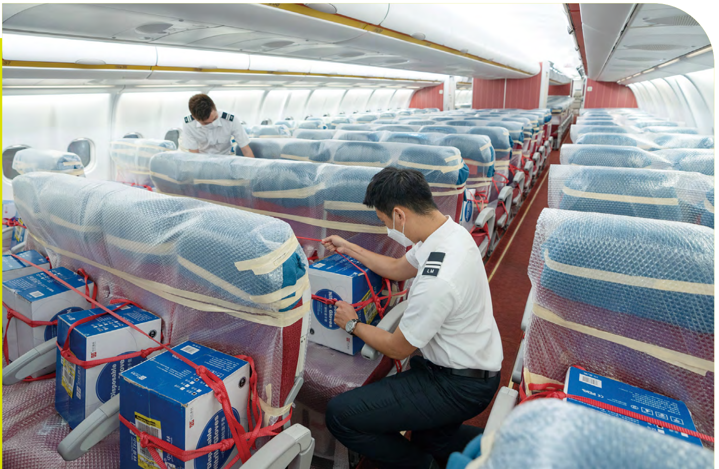
Cargo carriage on passenger seats in Hong Kong Airlines Airbus A330 aircraft. 香港航空空中巴士 A330 型號客機利用乘客座椅上運載貨物的情況。
