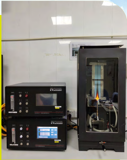
Flammability testing of materials used in the cabin 對客艙內使用的物料進行阻燃性測試
