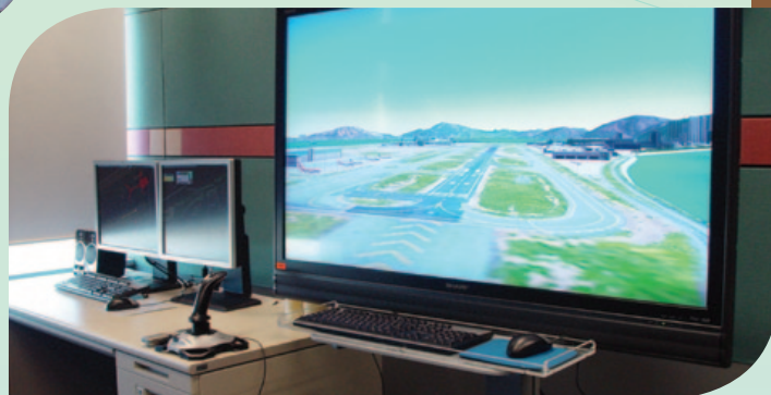
Stand-alone Playback Workstations of Phase 1 Control Tower Simulator. 新控制塔模擬機的獨立播放工作站。
