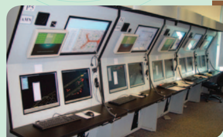
Pseudo Pilot Workstations of Phase 1 Control Tower Simulator. 新控制塔模擬機的仿機師工作站。
