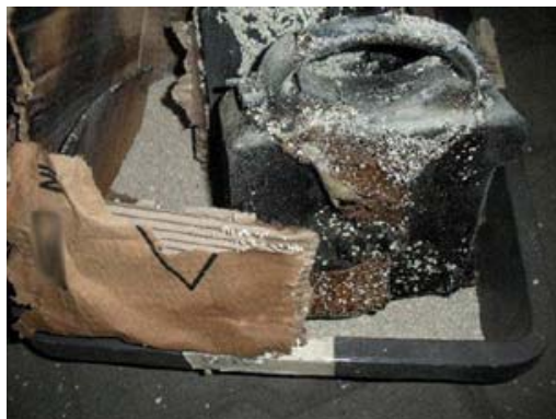
圖 1b 電池燃燒後的損壞情況
