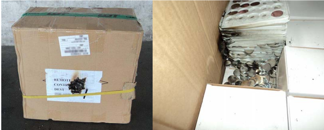
圖2 一箱「未經申報」的鋰金屬鈕形電池芯因短路發生火警
