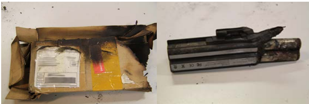
圖3 一枚「未經申報」供手提電腦用的鋰電池燃燒後的情況
