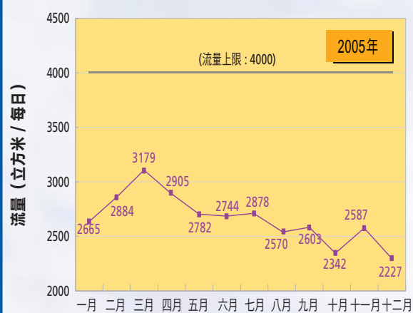
圖十五 備用空管大樓所排放的廢海水的流量
