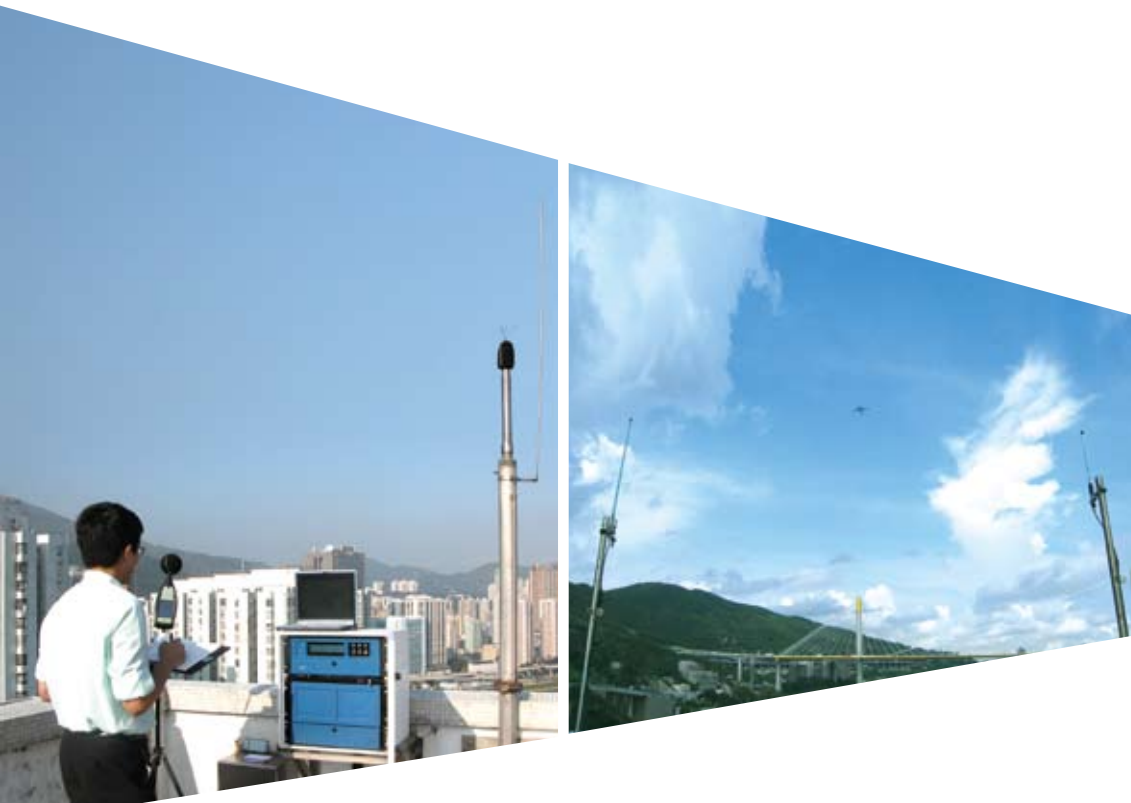
左圖：本處人員正收集飛機噪音數據。
